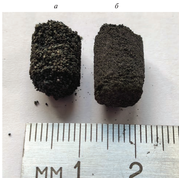
Рис. 4. Фотографии продуктов горения образцов насыпной плотности из МА-смеси: а – фракция 315–500 мкм, б – 40–125 мкм.
