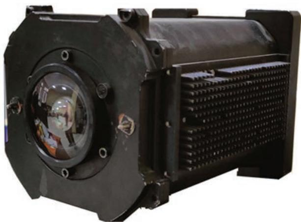
Рис. 4. Фотография монофотонного УФ-С-сенсора "Скорпион".
