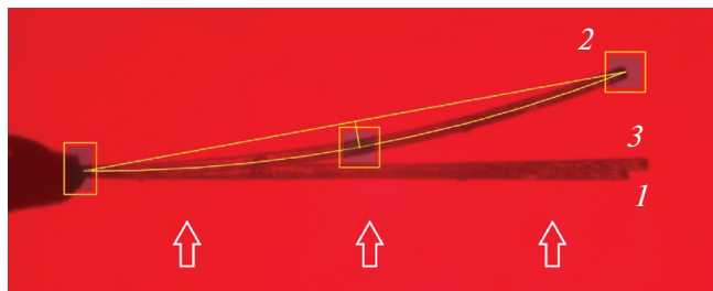
Рис. 4. Совмещенное изображение кристалла в трех последовательных стадиях процесса, показанного на рис. 3: 1 — начальное состояние, 2 — пик кривизны при засветке источником \lambda = 425 нм ( t = 10^3 с), 3 — пик кривизны, достигнутый после переключения с длины волны 425 на 350 нм ( t = 10^4 с). На изображении 2 показаны метки, используемые алгоритмом анализа формы кристалла. Стрелки указывают направление засветки кристалла.
