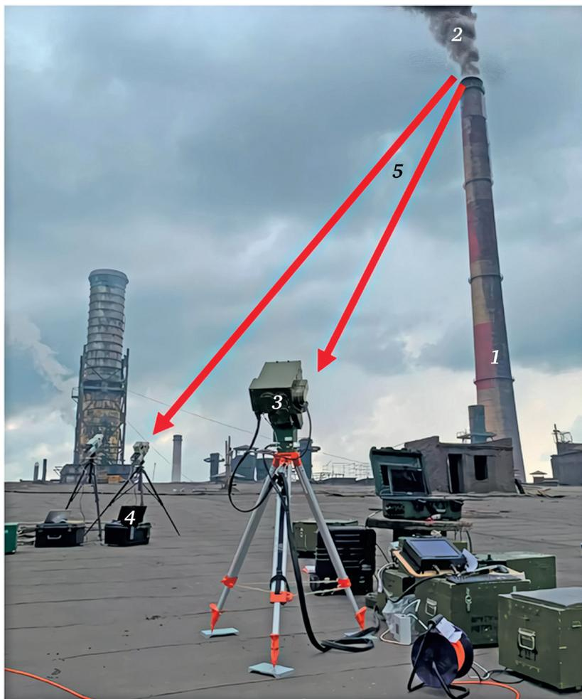
**Рис. 2.** Схема эксперимента по дистанционной регистрации ИК спектров отходящих газов ДТ: 1 – дымовая труба, 2 – отходящие газы, 3 и 4 – ИК-фурье-спектрометры, 5 – направления регистрации ИК-излучения.
